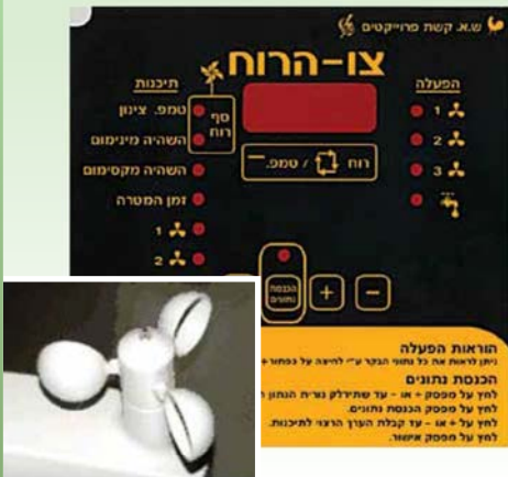
צו רוח - מערכת אוטומטית להפעלת קבוצות אורור וצינון לפי טמפ' ועוצמת רוח.
