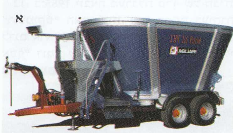
מערבלת אנכית בעלת שני חלזונות אנכיים. תוצרת פגליארי (Pagliari) איטליה משנת 1994 א. מבט חיצוני; ב. מבט פנימי.
