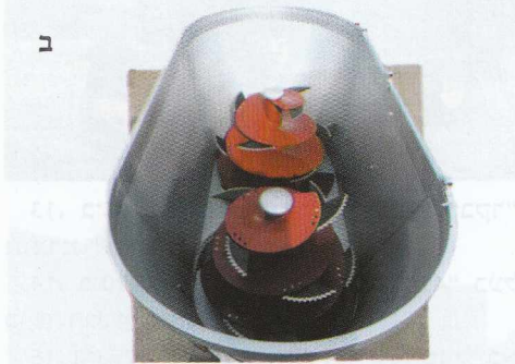
מערבלת אנכית בעלת שני חלזונות אנכיים. תוצרת פגליארי (Pagliari) איטליה משנת 1994 א. מבט חיצוני; ב. מבט פנימי.
