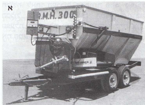
המערבלת הראשונה של חברת "תעשיות לכיש" דגם "לכיש 300" בנפח ברוטו של 8.5 מ"ק. א. מבט חיצוני; ב. מבט פנימי על שלושת החלזונות האופקיים.
