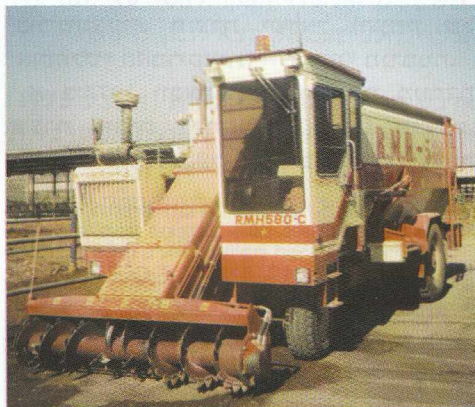
הסלף הישראלי האופקי תוצרת "תעשיות לכיש". בתמונה: מבט מלפנים של דגם "לכיש 580" שפותח ב-1993, ומבט מאחור של הדגם הראשון "לכיש 420" שלו מנוע מאחור, אשר פותח ב-1990.
