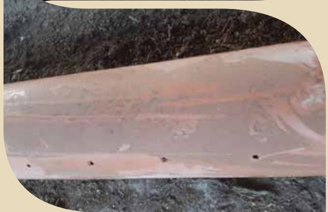
תמונה 2: חירור בצינור PVC קוטר 160 מ"מ. מאפשר יציאת אוויר לכל אורך הערמה.
