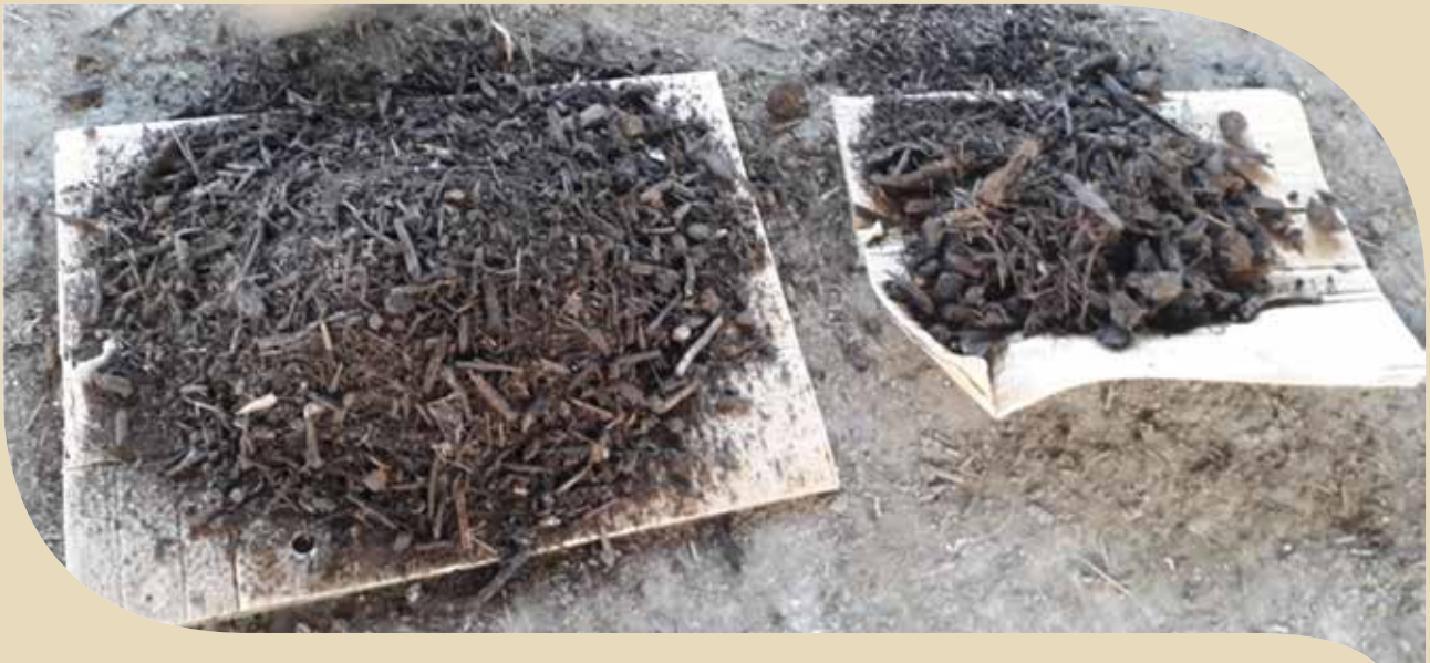
תמונה 6: איסוף דגימות למעבדה לאחר סיום התהליך. בצד ימין – דגימה לפני ניפוי. בצד שמאל דגימה לאחר ניפוי
