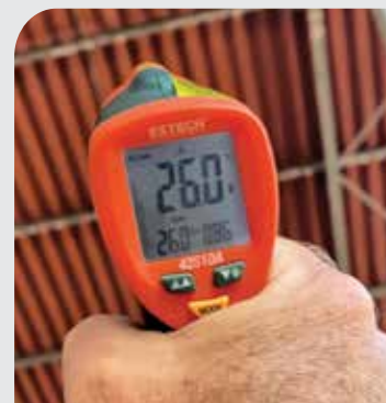
מדידת הטמפרטורה במקביל בשתי רפתות שכנות - תחת גג אדום של לנדיניבורד ותחת גג איסכורית
