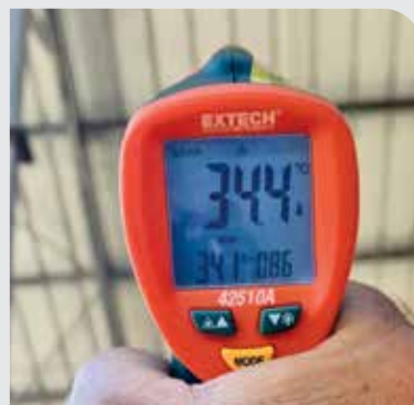
מדידת הטמפרטורה במקביל בשתי רפתות שכנות - תחת גג אדום של לנדיניבורד ותחת גג איסכורית
