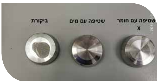
תמונה 2: דסקיות הנירוסטה לפני השטיפה ולאחר השטיפה במים ובחומר הנבדק
