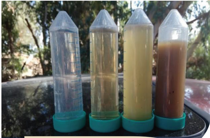
איור 2. מימין: מתקן טיהור שפכים כוללת סילוק נתרן על ידי מערכת טבעית ברפת כפר בלום. המערכת הוקמה ע"י צוות מיגל בסיוע של האיחוד האירופי במסגרת תכנית הוריון 2020-BRIGAD. משמאל: שפכי רפת בשלבי טיהור השונים. צילומים: סימון צ'רנואיבנוב
