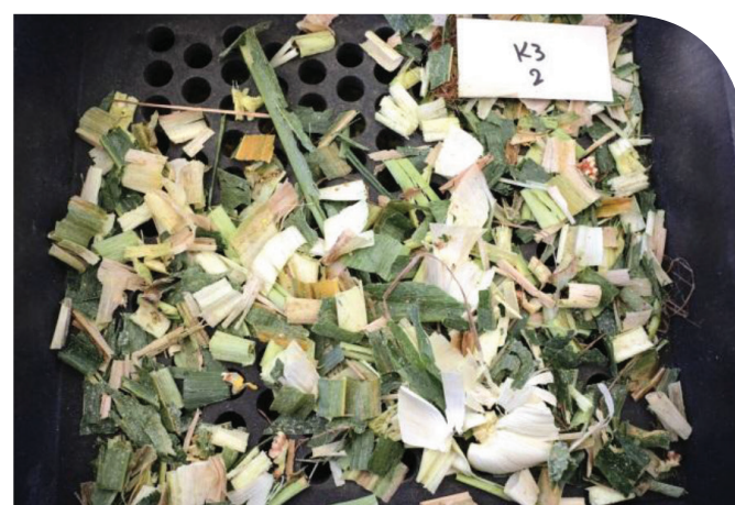
איור 4. חלקיקי תירס מעובדים מעל נפה 8, מימין Krone ומשמאל Class
