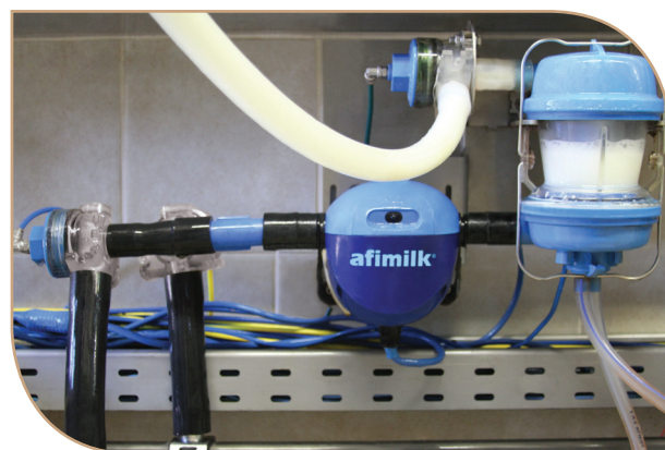
מכשיר אפילאב המורכב על קו החלב לאחר מד החלב ושני הברזים המכוונים את זרימת החלב לשני קווי חלב, למיכל A ולמיכל B
