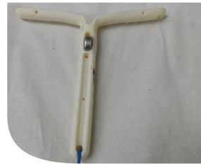
תמונה 1. התקן "סידר" נושא חיישן למדידת טמפרטורה תוך נרתיק של פרה
