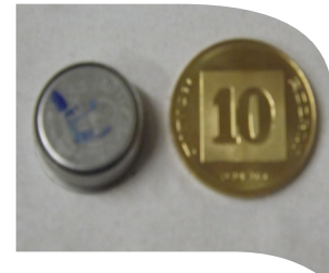
תמונה 1. התקן "סידר" נושא חיישן למדידת טמפרטורה תוך נרתיק של פרה
