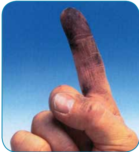
התפרקות הגומי וסימני פיה כתוצאה מהשפעת הכלור על הגומי
