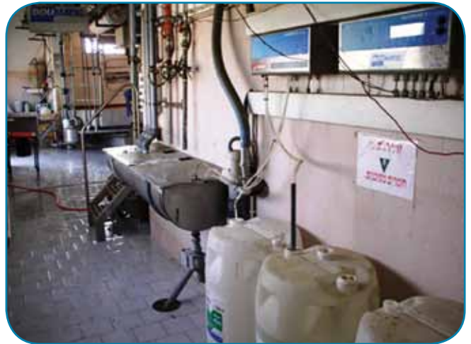
מערכת שטיפה המורכבת ממערכת פיקוד וברזים מפקדים + מכלי חומר ניקוי
