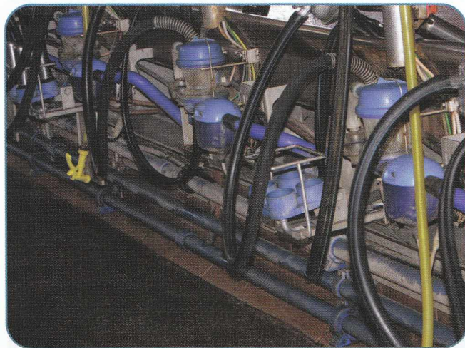
מכשיר אפילאב תוצאת צח"מ ברפת וולקני. המכשיר מודד הרכב חלב מקוון כל חליבה לכל פרה
