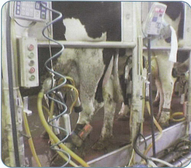
"מד רביצה" שנבנה במכון להנדסה חקלאית ארוז בקופסאות תגי הזיהוי של צח"מ אפיקים
