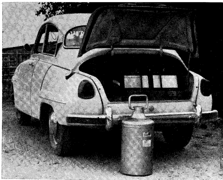
מיכל לעבודת שדה לאיסוסן זירמה קפואה המשומרת בחנקן נוזלי (טמ' 196^{\circ}\text{C} ) —
