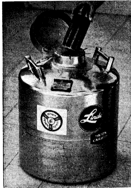
מיכל לזירמה קפואה, משומרת בחנקן נוזלי בטמפרטורה של מינוס 193 מעלות צלזיוס
